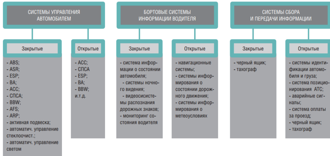
Рис. 3. Классификация бортовых систем интеллектуального автотранспортного средства
